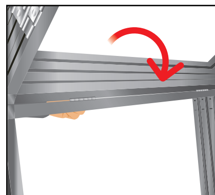
6. Overdelen vipkes ned mod den synlige del af hængslerne. (pas på balancen)
